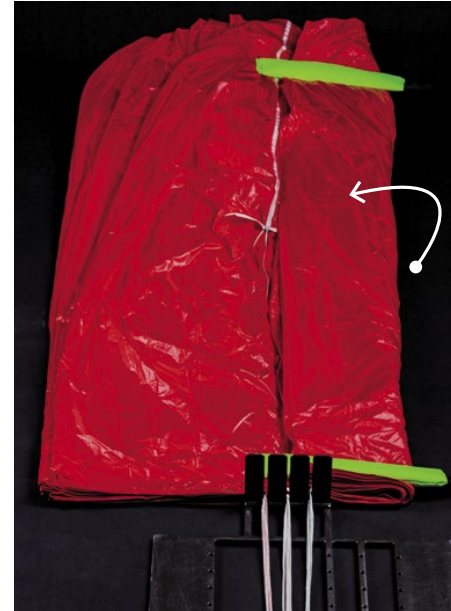
Halbiere die rechte Kappenhälfte zur Mittelachse.
