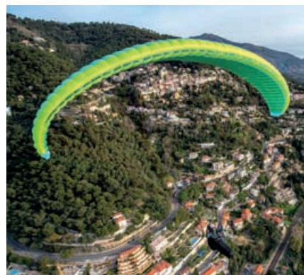
Technologie propre à Nova, les « smart cells » sont de largeurs légèrement différentes suivant les efforts. Pour une meilleure homogénéité d'ensemble dans la masse d'air, et favoriser aussi la glisse.
