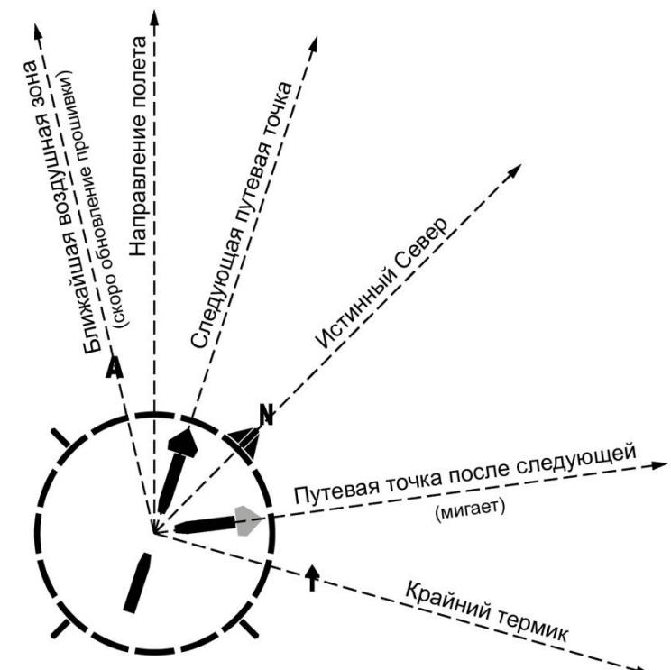
В полете Flytec Element будет показывать направление к вашей следующей путевой точке в виде стрелки на розе компаса. Для полета к следующей путевой точке вашего маршрута поворачивайте парашют, пока острие стрелки не окажется вверху розы компаса.
