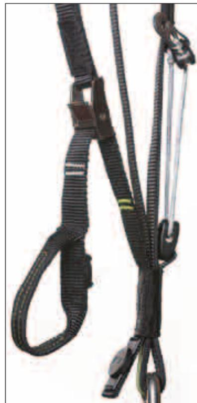
La boucle de la sangle des trims est facile à saisir. Un aimant à la base de l'élévateur évite que la sangle flotte au vent. Il est possible de connecter le barreau d'accélérateur aux avants.
