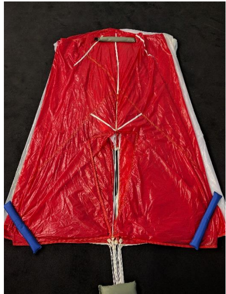
10. Legen Sie nun Bahn 1 wieder mittig zum Boden und ziehen Sie die nächsten Bahnen heraus. Wiederholen Sie Punkt 5 bis Sie wieder die Mitte erreichen.
