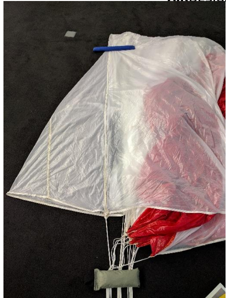
4. Bahn 1 mittig auf den Boden legen und Bahn 2 herausziehen.
